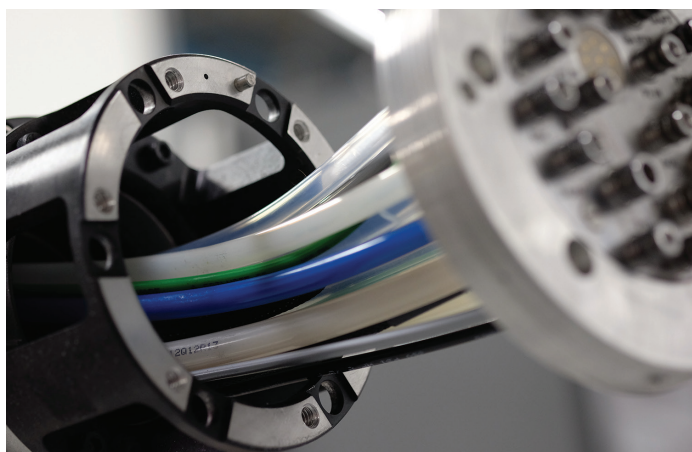
Oznaczone kolorami wiązki przewodów dla łatwiejszej wymiany oraz wydajności operacyjnej.
