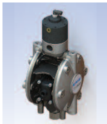
Model ze stali nierdzewnej z komorą wyrównawczą (dla zastosowań, w których filtr cieczy może spowodować jej rozwarstwienie). Specyfikacja zamówieniowa: DX200SP.
